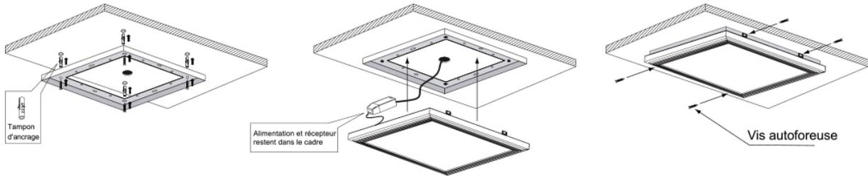
⚠ L'installation de cadres de fixation alu apparents, déportés ou francs-bords requiert d'effectuer une mise à terre sur chacun des cadres.
