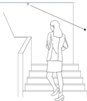
Facile à installer en lieu et place d'un interrupteur, ce produit est un détecteur de mouvement à infrarouge à faisceau ponctuel et temporisé. Toute activité à moins de 3 m de la sonde, durant cet intervalle, relançant automatiquement le plafonnier à un rayon d'action d'un mètre.
