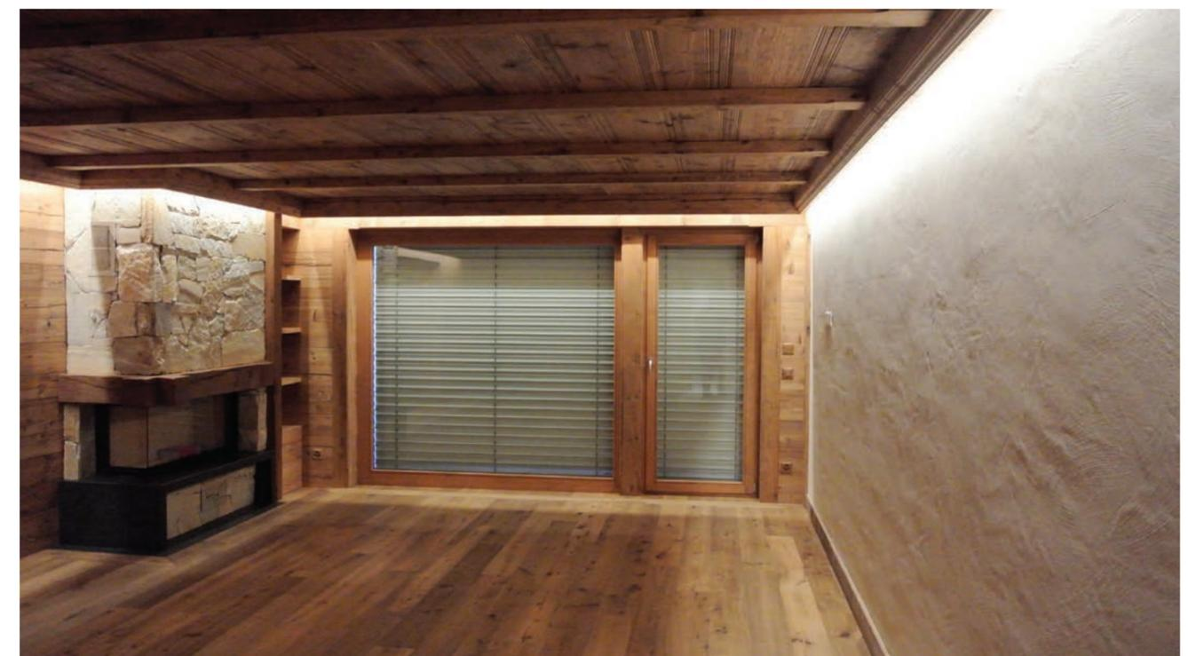
Avec ce ruban, équipé de 240 LEDs/m, le point lumineux est totalement effacé. Il est la garantie d'une lumière linéaire – en éclairage direct et sur profil fin.
