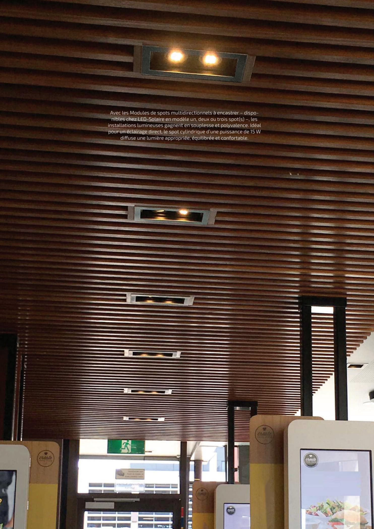
Avec les Modules de spots multidirectionnels à encastrer – disponibles chez LED-Solaire en modèle un, deux ou trois spot(s) –, les installations lumineuses gagnent en souplesse et polyvalence. Idéal pour un éclairage direct, le spot cylindrique d'une puissance de 15 W diffuse une lumière appropriée, équilibrée et confortable.
