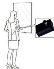
Cet interrupteur *one-touch* s'active au simple toucher du doigt et allume instantanément la source lumineuse ou l'installation LED. Il est muni d'un voyant lumineux qui permet de le localiser facilement la nuit. Simple à installer, il est spécialement conçu pour les dressings, armoires et autres meubles nécessitant un éclairage. Il est relié au boîtier de gestion par un câble plat d'un mètre.
